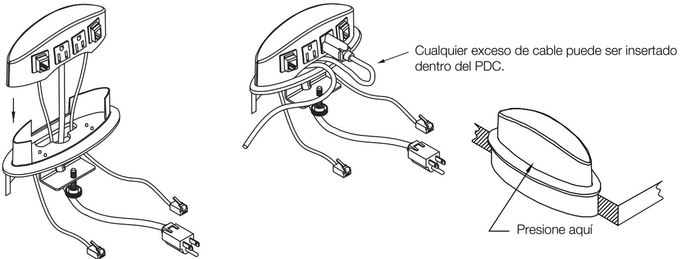
Inserte los cables de energía y comunicación a través de la base del PDC.
