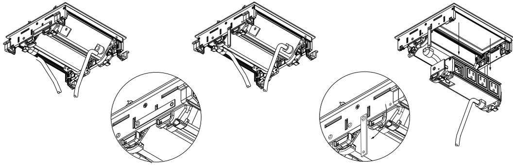
Para extraer y volver a montar unidades de potencia del conjunto de ojal . Nota: Para la versión con cable solamente.
