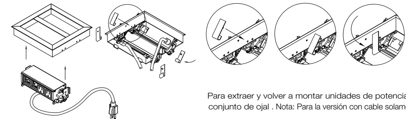
Para extraer y volver a montar unidades de potencia del conjunto de ojal . Nota: Para la versión con cable solamente.
