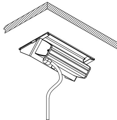
**NOTA:** En la aplicación de conducto, éste debería estar soportado de acuerdo al código local. Cuando se estén sacando los cables y el conducto de la unidad, asegúrese de espacio suficiente que permita a la unidad abrirse apropiadamente.
